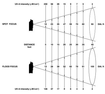
RADIOMETRIC DATA FOR HPA400/30-S LAMP
